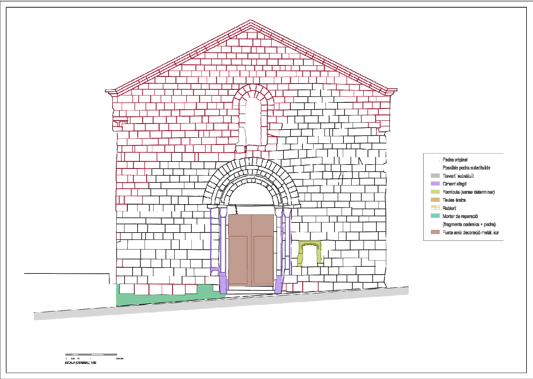
Planimetries referents als materials constitutius de la façana. S'aprecia la gran quantitat de carreus i altres materials substituïts que es poden relacionar amb el seu estat de conservació
