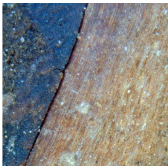
023_0115_AT_ML_bastidor_espiga.jpg Espiga rodona, falcada en un dels marges del bastidor
