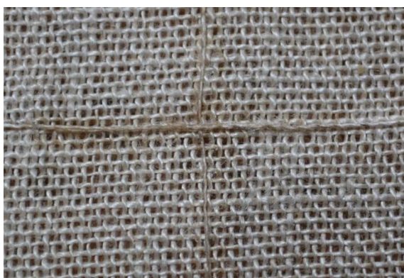
174_0115_proves_adhesiu.JPG Mowilth DM5. Un cop sec s'observen els fils lleugerament més brillants.
