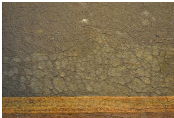
152_0115_test_aquos2.jpg Solució tampó buffer pH 5,5 gelificat amb Agar. S'observa l'alteració de la capa de superfície creant zones lleugerament més emblanquinades.
