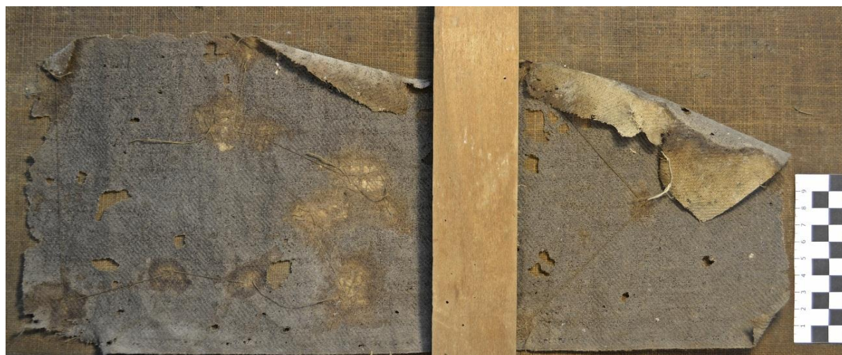
066_0115_AT_pedaç.jpg Primer pedaç altament degradat per l'atac xilòfag ocasionant pèrdues i alterant als diferents estrats constitutius de l'obra.
