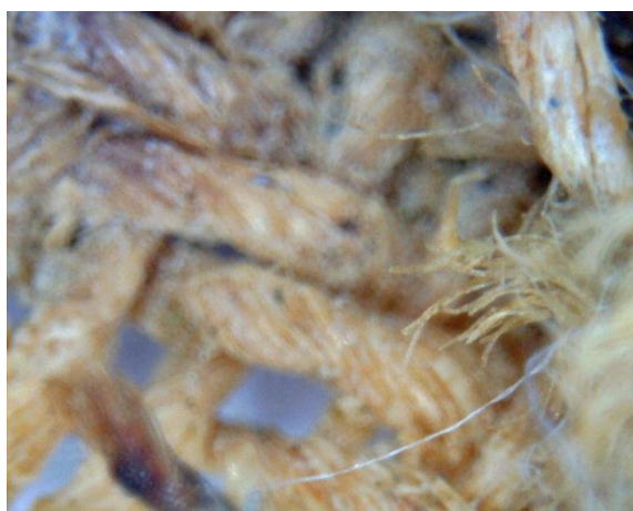
109_0115_pedaç2.jpg S'observa l'estructura de sarga de fils homogenis.
