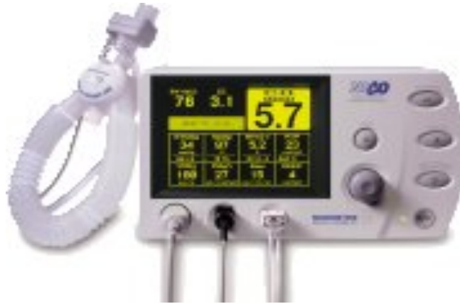
Figura 1: Monitor NICO y sistema de tubuladura circular con capnógrafo. La tubuladura se conecta al circuito respiratorio y al monitor respectivamente. (Imagen obtenida de www.wilhelm.ro )
