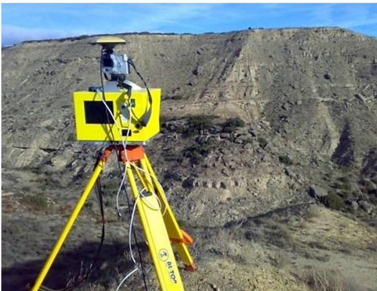
Figura 67. Dispositivo TLS utilizado en esta tesis en pleno proceso de adquisición de datos de la vertiente de Barranco Hondo (afloramiento de Montearagón). Sobre el escáner se pueden observar tanto la cámara de fotos externa como la antena del GPS.
