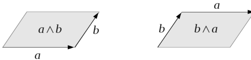
Figura 2.4: Regla del paralelogramo para el producto externo. El orden de las flechas sobre las aristas determina la orientación del paralelogramo. Las flechas indican el camino de un punto, trazando primero un segmento de línea y luego este segmento de línea se mueve barriendo el espacio formando el paralelogramo.
