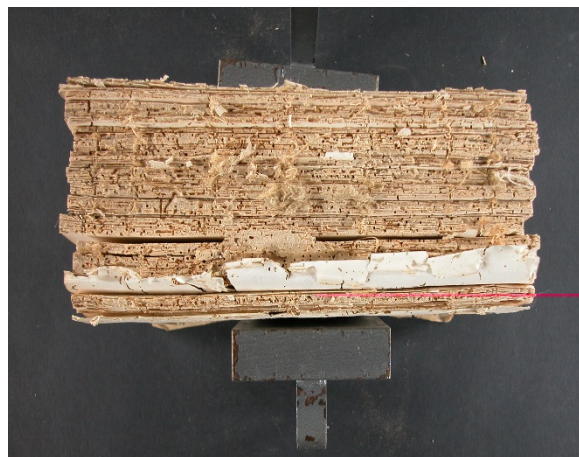
Cosit perdut a causa dels insecte
