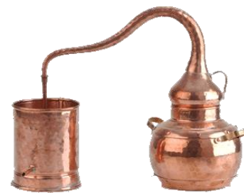
Figura 1: alambí de destil·lació
