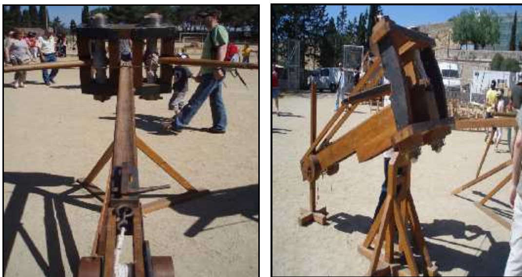
Fig. 38 i 39: Fotografies d'una catapulta tipus scorpio (esquerra) i d'una ballista (dreta) (Autor).
