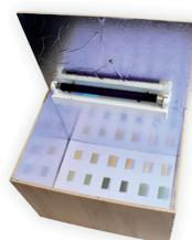
La prueba de resistencia a la radiación ultravioleta se ha realizado mediante una lámpara de Wood de 7 vatios, colocada estáticamente en la parte superior de la caja proporcionando una iluminación cenital uniforme de 0,35 MWcm<sup>3</sup> (aproximadamente unos 60 lux), emitiendo a una longitud de onda de 360nm.
