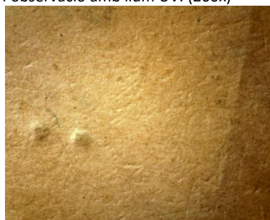
Imatge 84. DOC77_AT_ML_LLRR_relleu.bmp Pel revers del paper, els caràcters impresos tipogràficament, apareixen en relleu. (60x)
