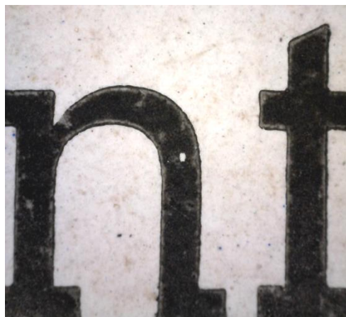
Imatge 12. DOC11_AT_ML_tinta.bmp Tinta d'impressió d'un element tipogràfic. (60x)
