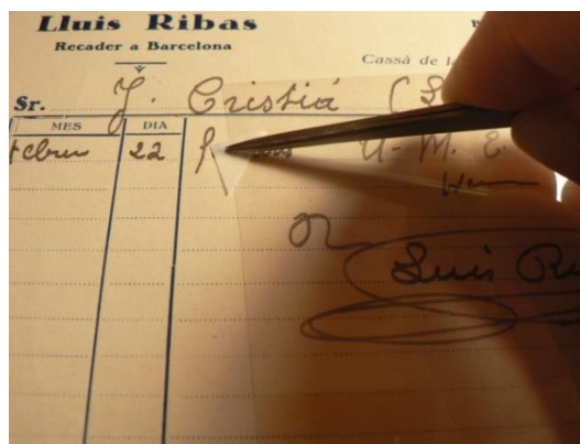
Imatge 110. DOC48_AT_LLN_test_fell_4.jpg Es posa en contacte una punta del triangle de paper test amb un traç de tinta; es subjecte amb les pinces i es situa un tros de Melinex® per sota del paper que no està en contacte amb la tinta.
