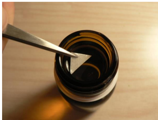
Imatge 108. DOC48_AT_LLN_test_fell_2.jpg Agafant el paper test amb unes pinces inoxidable, s'humecta amb aigua destil·lada.
