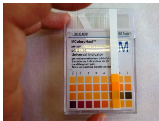
Imatge 37. DOC132_resultat_mesura_ph.jpg La tira indicadora mostra un pH aproximat de 5.
