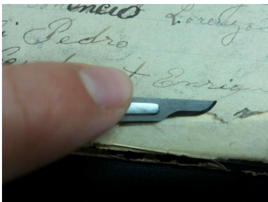
Imatge 92. AT_LLN_proces_extraccio_mostra.jpg S'extreu una mostra del suport amb un bisturí amb la fulla ben horitzontal.
