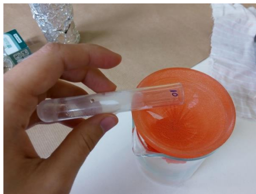
Imatge 95. AT_LLN_proces_neteja_mostres3.jpg Es col·la el contingut del tub amb una mitja sintètica per a separar la mostra.
