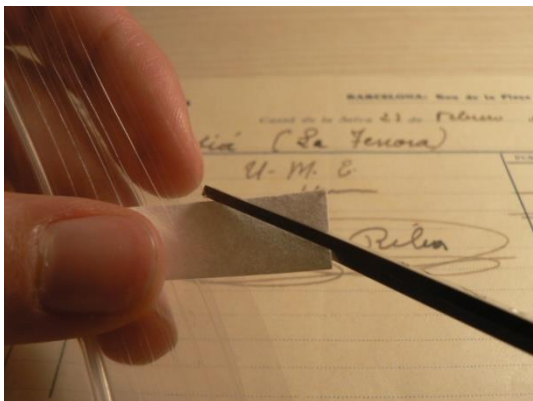
Imatge 107. DOC48_AT_LLN_test_fell_1.jpg Es talla un triangle petit d'una tira de paper test.
