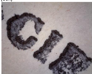
Imatge 85. DOC153_AT_ML_segell.bmp Detall de la tinta de segell tampó; els elements són poc definits i la tinta té tendència a escórrers. (60x)
