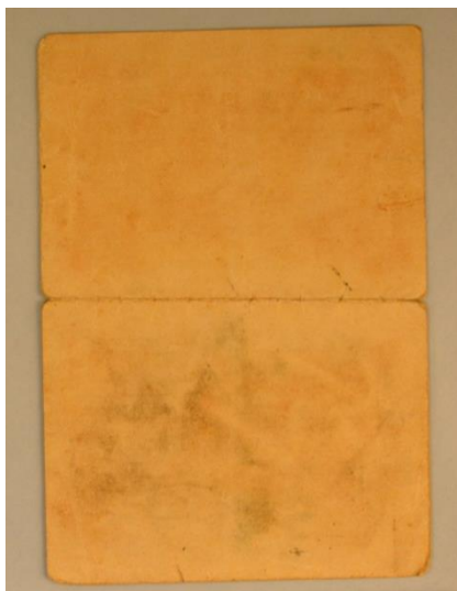
Imatge 53. DOC143_AT_LLN_canvi_cromatic_suport.jpg Canvi cromàtic del suport elevat; pot ser degut, segurament, al propi envelliment i acidesa del paper.
