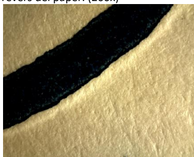
Imatge 83. DOC91_AT_ML_LLRR_solc_impresio.bmp Amb el microscopi de superfície i la llum rasant els solcs de la matriu tipogràfica apareixen molt més definits. (60x)
