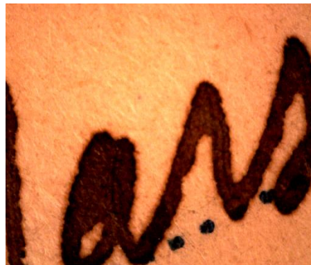
Imatge 78. DOC51_AT_ML_tinta.bmp El color de la tinta és de marró intens i és bastant opac. S'aprecia una petita acumulació de tinta a les vores del traç i una lleugera aurèola al voltant. (60x)
