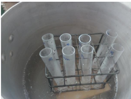
Imatge 94. AT_LLN_proces_neteja_mostres2.jpg Es posen els tubs d'assaig amb les mostres al bany maria durant uns minuts.
