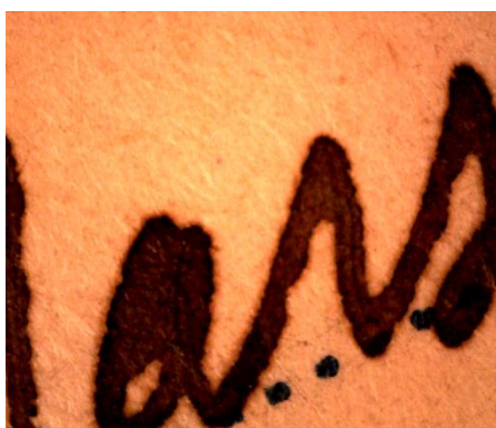
Imatge 38. DOC51_AT_ML_tinta.bmp Detall de tinta metal·loàcida; amb el temps es torna de color marronós i s'aprecia una lleugera aurèola al voltant del traç. (60x)
