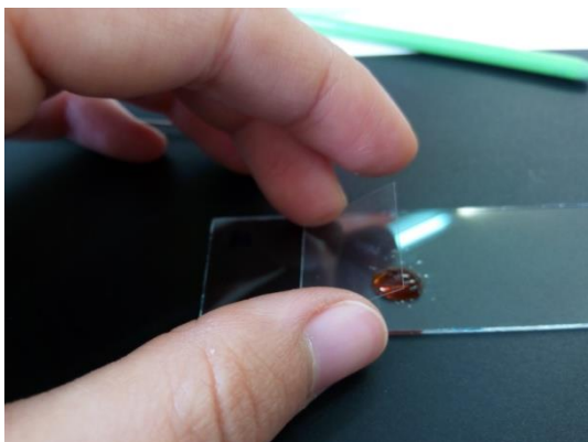
Imatge 98. AT_LLN_preparacio_mostres2.jpg Es cobreix la mostra i el reactiu amb un cobreobjectes.
