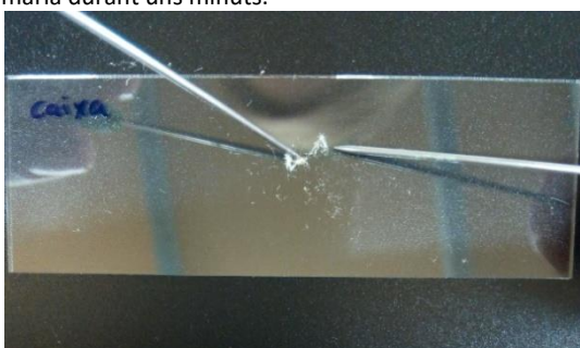
Imatge 96. AT_LLN_preparacio_mostres.jpg Un cop seca la mostra es desfibren les fibres amb dues agulles emmanegades.
