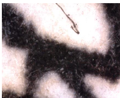
Imatge 79. DOC6_AT_ML_tinta.bmp Traç de tinta metal·loàcida sense llum UV; costa distingir si realment és metal·loàcida. (200x)
