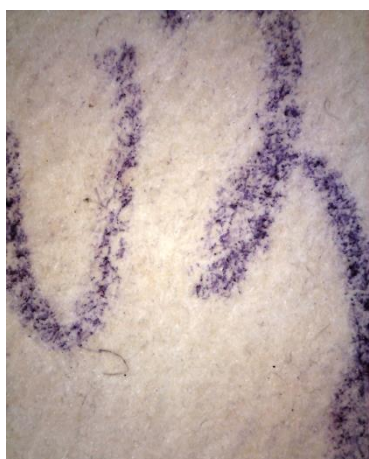
Imatge 87. DOC160_AT_ML_llapis_color.bmp Detall d'elements fets amb llapis de color; les partícules del material es disposen entre les fibres i la superfície del paper. L'element és poc definit i amb disposició irregular de partícules. (60x)
