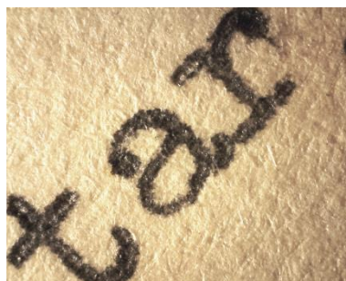
Imatge 86. DOC80_AT_ML_tinta.bmp Detall d'elements mecanografiats; s'aprecia lleugerament el solc del caràcter al paper i el traç poc definit. (60x)
