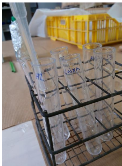
Imatge 93. AT_LLN_proces_neteja_mostres.jpg Es col·loquen les mostres en tubs d'assaig (identificats amb el nº de mostra) i s'afegeix aigua destil·lada.
