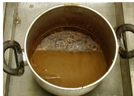
Fig. 45 i 46. Deixeu refredar la cera fosa mantenint el recipient en posició lleugerament inclinada.
