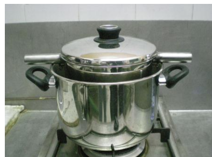
Fig. 1. Bany maria: olla de fusió de ceres a l'interior de la cassola
