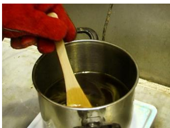
Fig. 40. Remeneu la barreja. Fig. 41 i 42. Retorneu la barreja al recipient del bany maria.
