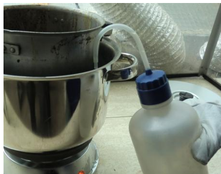
Fig. 23. Comproveu el nivells d'aigua i si en cal, afegiu-n'hi. Si falta aigua la cera es pot cremar.
