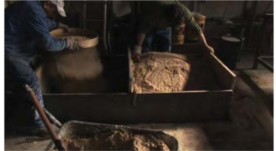
▷ ▽ 58, 59, 60, 61 y 62. Proceso de preparación de los moldes para la fundición de las placas vertido del bronce, Antonio López, 2008. Fundición Arte 6, Arganda del Rey, Madrid
