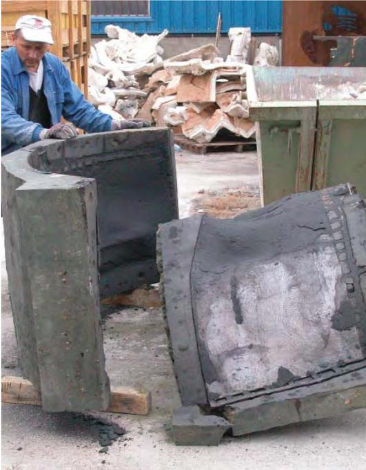
Después de los retoques se desmontan las 25 piezas y se funden a la arena, ahorrando la necesidad de hacer un molde, un positivo en cera, y se utiliza el mismo sistema indirecto proyectado por Leonardo de dar grosor a la superficie (fig 64), mediante planchas de espuma que se traducirían en el grosor definitivo de aproximadamente 1 cm de la figura definitiva en bronce (ver fotografía).
