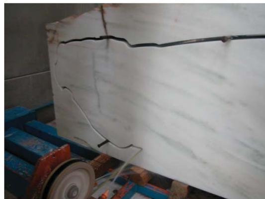
△33. Corte con hilo diamantado del perfil del cuerpo del acs mil
