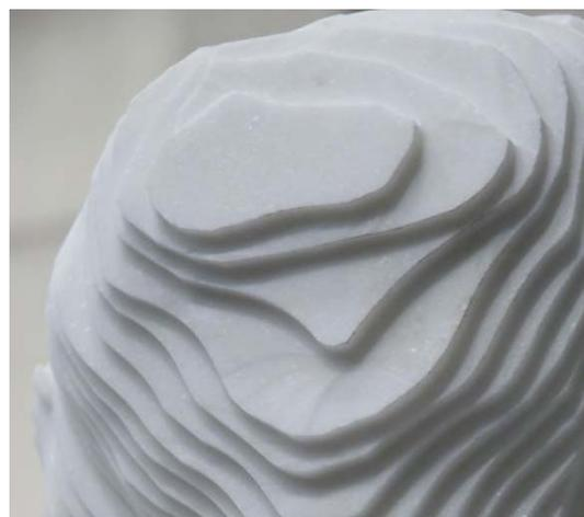
▷ ▽ 25, 26, 27 y 28. resado del Escupali de Empuries, fresado por robot de control numérico. Inicio del segundo desbaste
