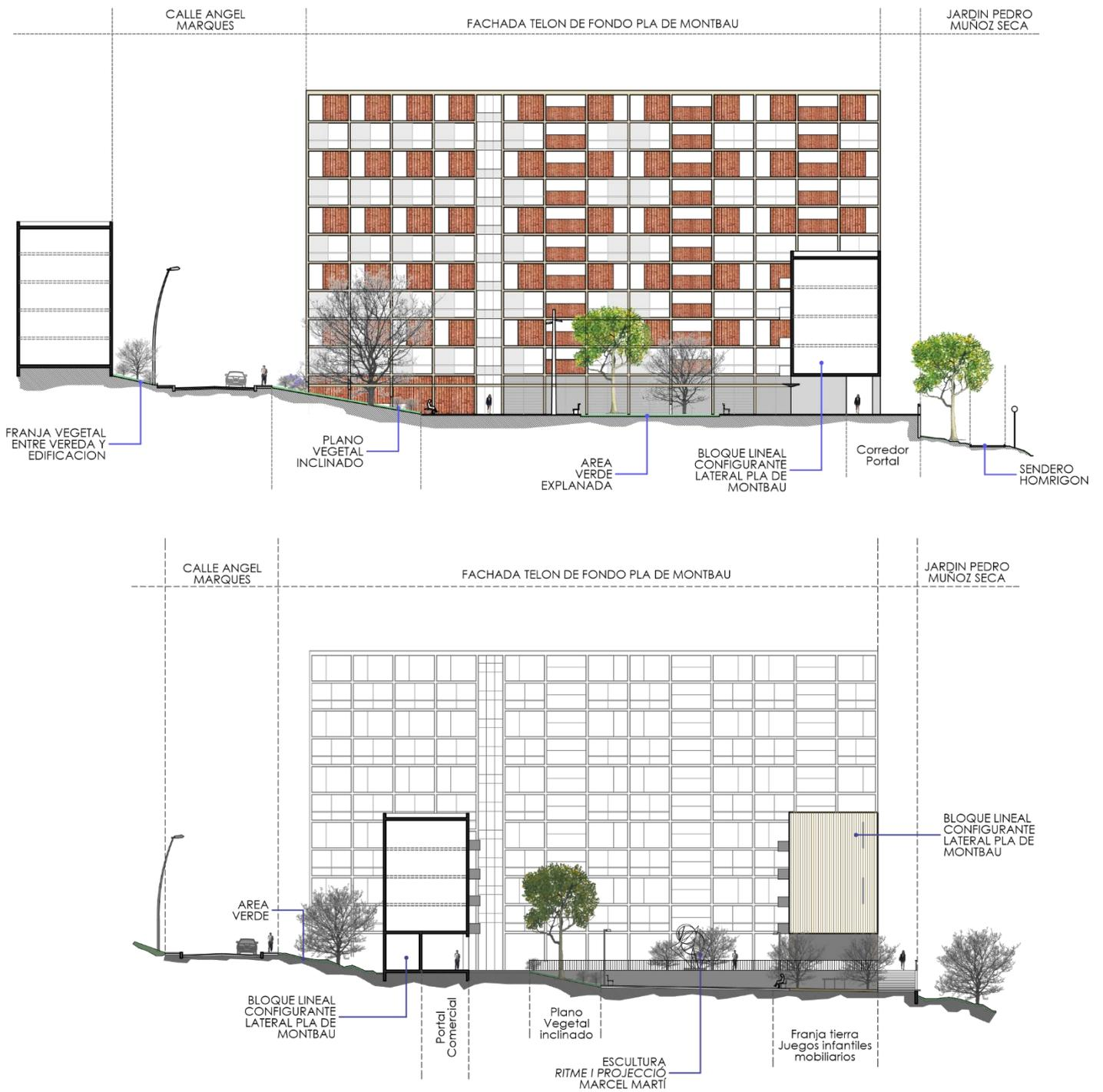
Fig. 3.22 y 3.23 Cortes Transversales A y B de Pla de Montbau. Se puede apreciar con mayor claridad como las fachadas adquieren mayor protagonismo de los planos verticales que configuran el espacio público.
