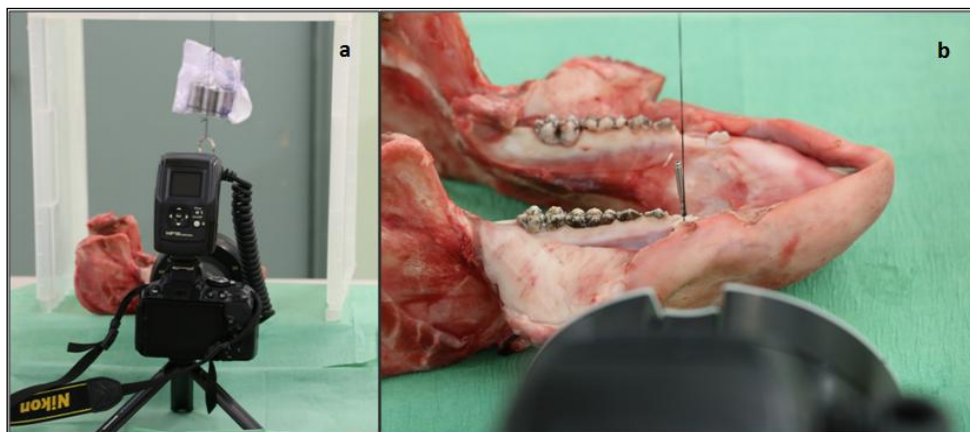
Figura 4: a) Muntatge del sistema de politges amb la càmera de fotos estandarditzada (trípode). b) Tracció del penjoll, el qual s'alça envers un punt determinat de la fresa calibrada, permetent enregistrar-ne l'extensió mitjançant la fotografia.
