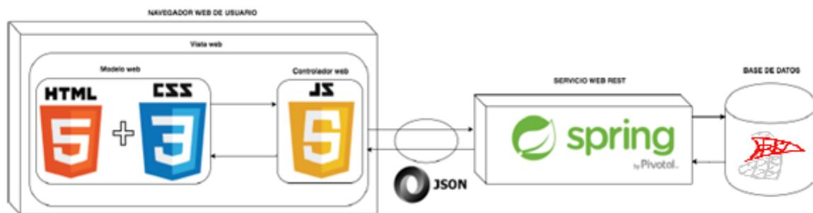
Figura 4: esquema de la arquitectura de la aplicación
