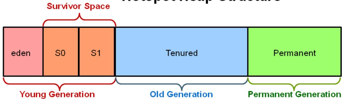
Ilustración 2: Estructura Heap de la JVM
