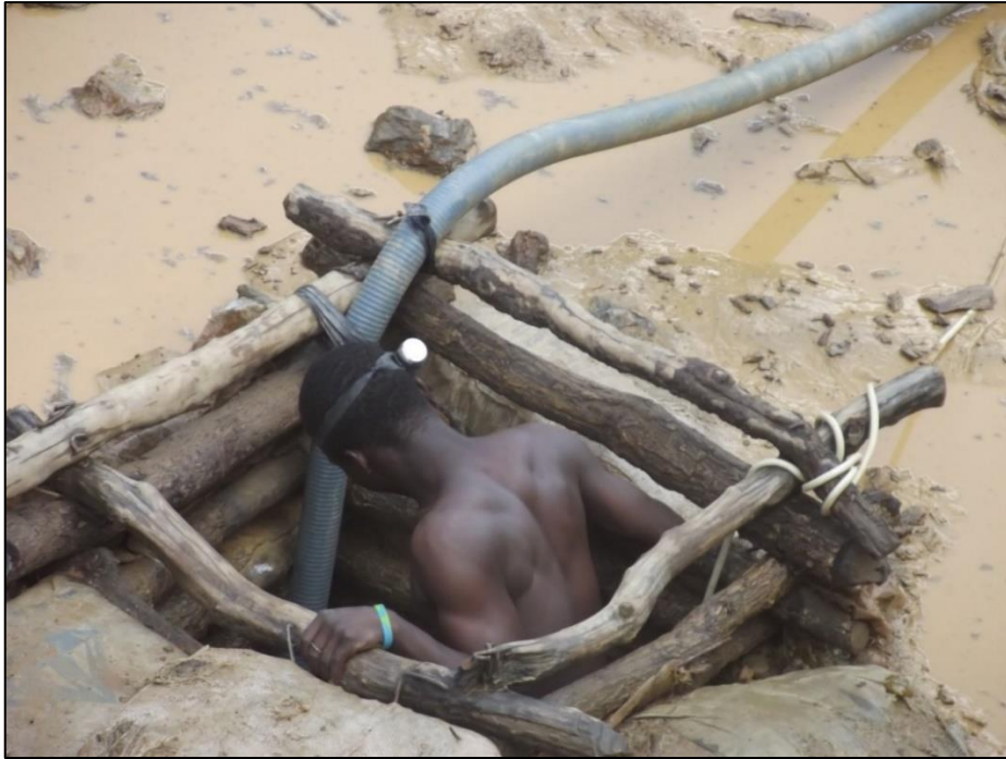
Figura 1.1.12. Accés d'un miner a la mina subterrània. A l'interior una bomba extreu l'aigua per evitar les inundacions de l'àrea de treball.
