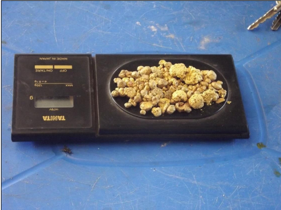
Figura 1.1.14. Or tractat a peu de mina. Operació de pesada sobre balança electrònica. Or amb fase d'amalgamació que l'hi dona un aspecte com de sucre. Font: Serra, 2012.
