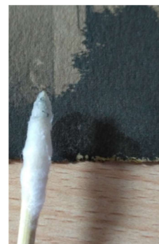
Fig. 64 Imatge II: solubilitat amb aigua destil·lada calenta
