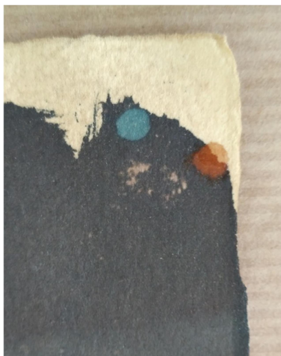
Fig. 68 Imatge II : reacció en contacte amb l'hidròxid de sodi, s'observa un canvi de coloració cap a un to ataronjat
