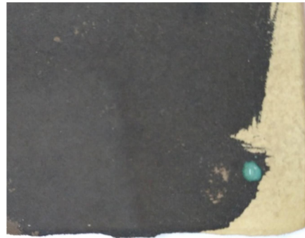
Fig. 66 Imatge II : anàlisi amb àcid clorhídric, s'observa un canvi de coloració provocat per l'àcid.
