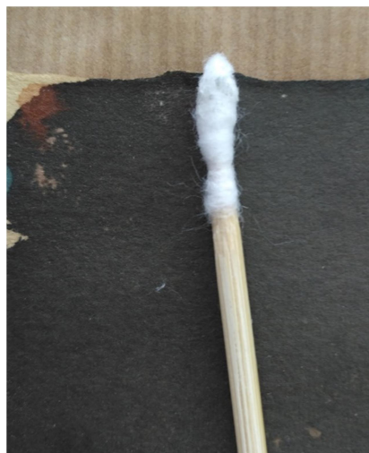
Fig. 70 Imatge II : resultat de l'anàlisi amb nitrat de bari en medi aquós. S'observa un lleuger despreniment del pigment que conforma la imatge.
