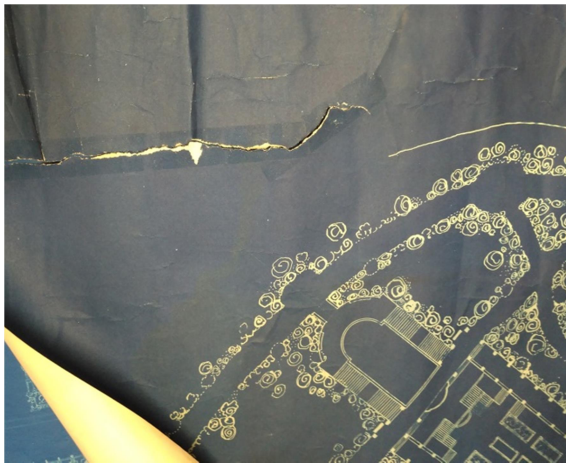
Fig. 33 Ferroprussiat de l'exposició Universal de 1929 amb un esquinçament, arrugues i restes d'adhesiu.
