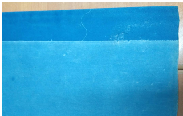
Fig. 37 Detall d'un dels marges d'un plànol ferroprussiat, s'observa la presència de fils que van formar part del suport de tela del plànol original.
