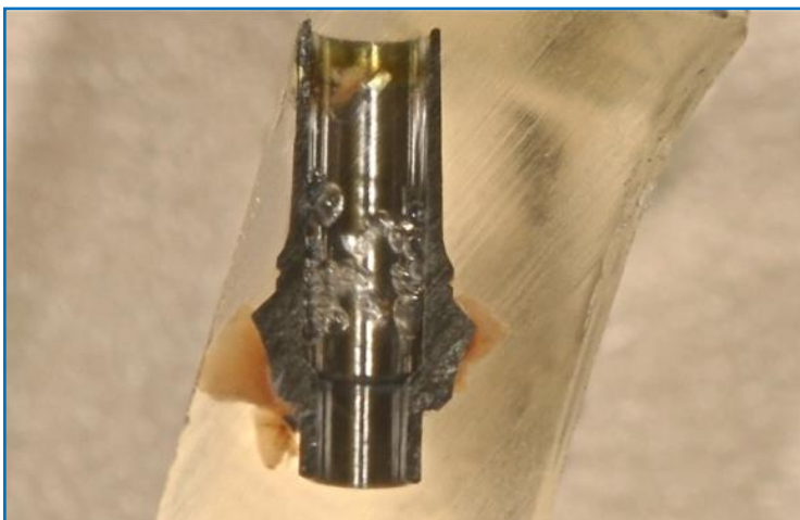
Figura 5.14. Primera sección obtenida tras el corte por el eje longitudinal del pilar.
