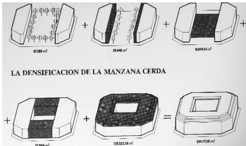
Fig.17. Densificación de la manzana Cerdà por causa de las distintas ordenanzas edificatorias. Fuente (Fernández Ordoñez, J.A.; Soria y Puig, A; Tarragó Cid, S (Coord), 1976)
