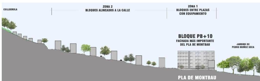
Fig.279. Sección transversal del Polígono de Viviendas Montbau. Relación entre las fachadas de los edificios y el espacio que configuran. El escalonamiento del terreno permite un buen asoleamiento de las fachadas del barrio. Fuente elaboración propia.
