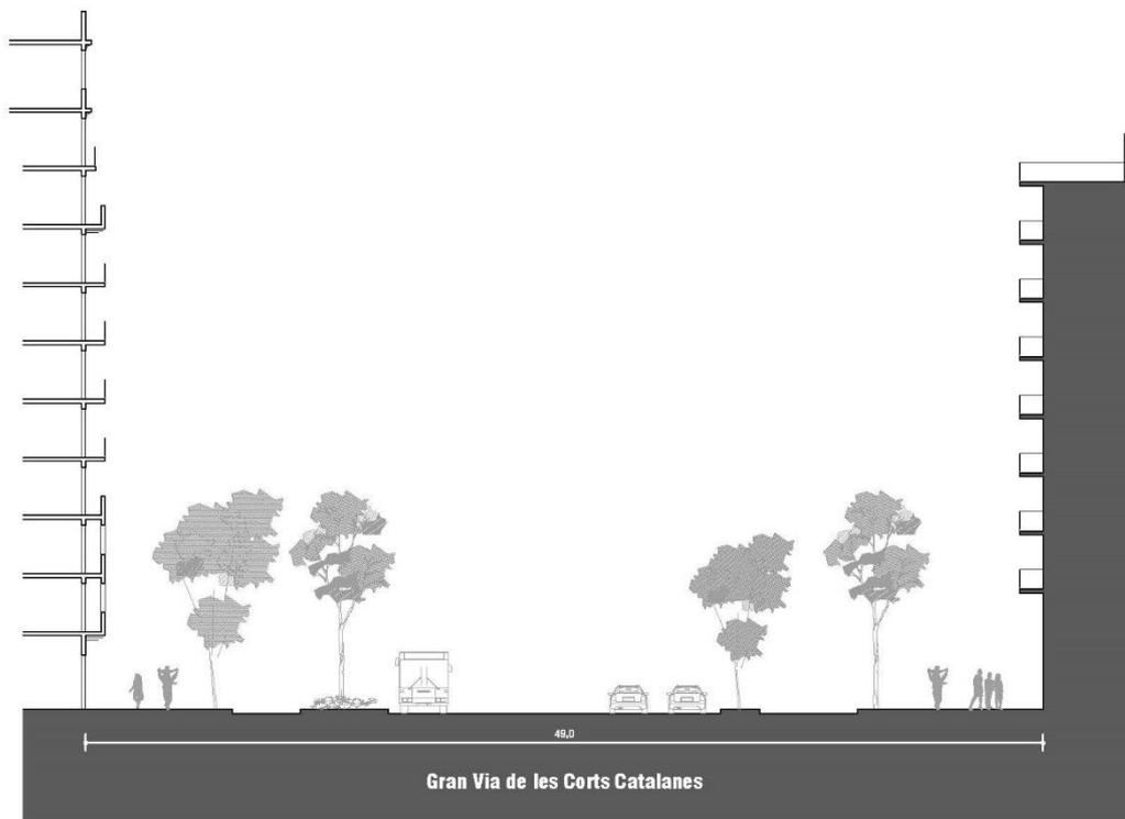
Fig.215. Sección tipo de la Av. Gran Vía. A pesar de que la altura de las fachadas es bastante alta, la relación con el ancho de la calle es correcta. Fuente elaboración propia.
