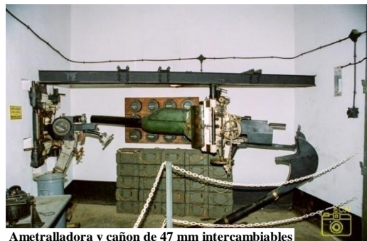
Ametralladora y cañón de 47 mm intercambiables
