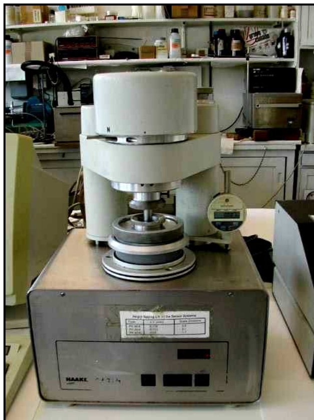
Figura II.3.3. Detalle del dispositivo de medida del réómetro Rotovisco CV20.
