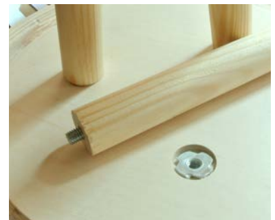
La unión incorrecta. Se trata de enroscar la pata en la superficie superior del asiento
