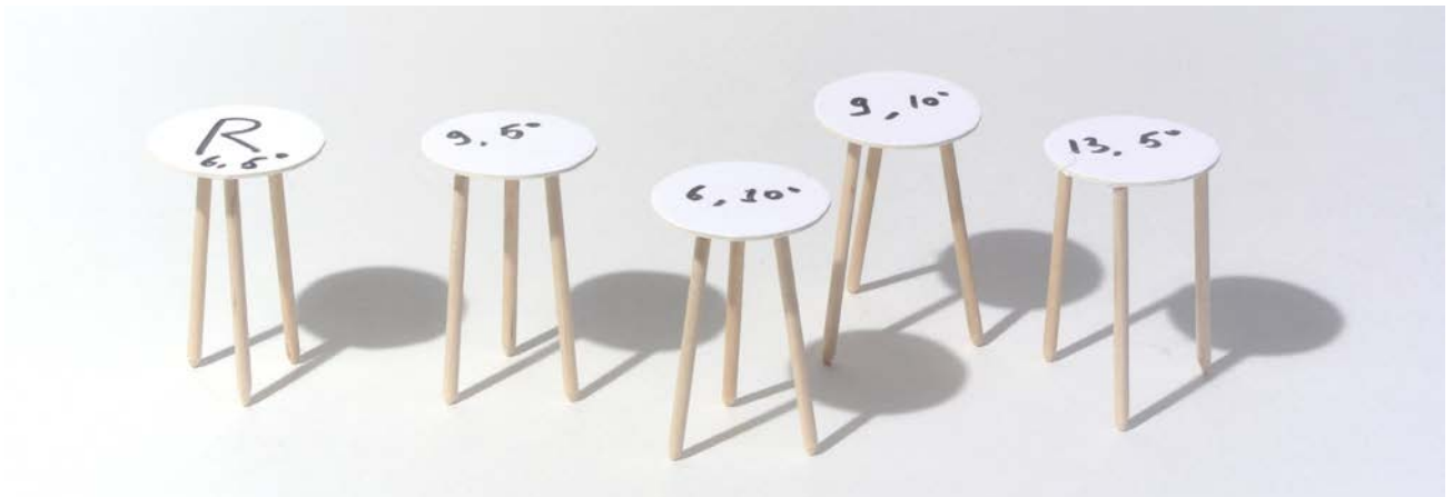
Prueba de diferentes inclinaciones de las patas y de distancias diferentes entre la unión patas-asiento y el centro del asiento. Maqueta a escala
