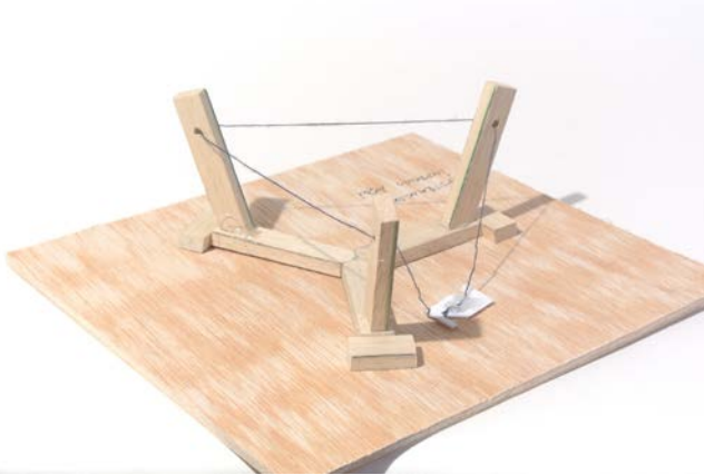
La unión a base de tensión. Al estirar la cuerda mediante el gancho las patas se fijan en su sitio
