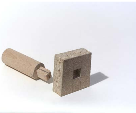
La unión a base de presión ( snap fit ) característica para piezas de plástico. Se aprovecha de la flexibilidad que tiene madera.
