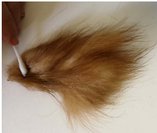
Annex 11: Reversibilitat de les tintes acríliques en etanol sobre un retall de pelatge
