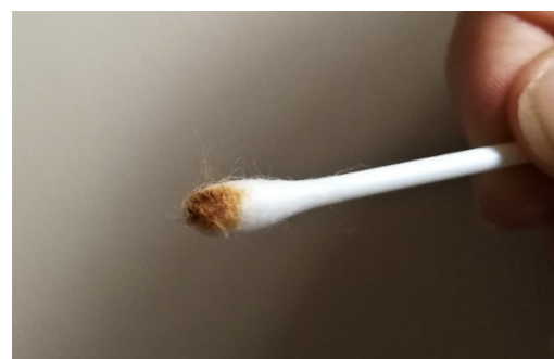
Annex 8: Reversibilitat de la pintura acrílica en etanol sobre un retall de pelatge
