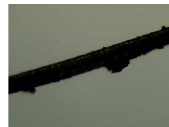
Fig. 76: Pèl de Martes foina amb pintura a oli amb tricloroetilè (x10)
