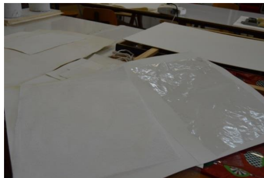
Fig. 3.50. El paper secant, Reemay® i Melinex® preparats mentre el paper s'humecta.
