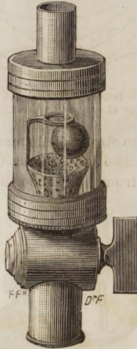
Fig. 385. Mecanismo de la válvula y del filtro en forma de embudo.
