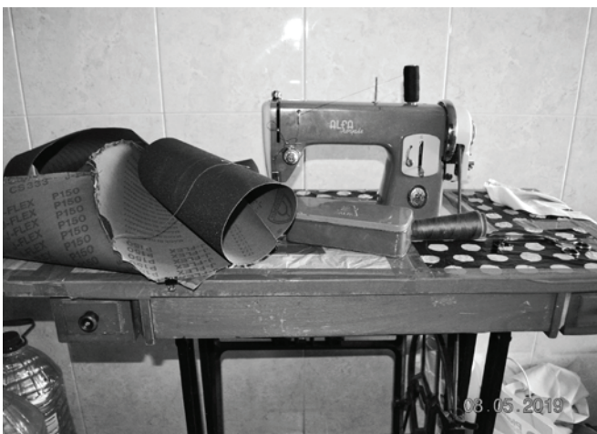
Figura 3: Cosint. La màquina de l'àvia amb una protecció improvisada contra l'abrasió.
