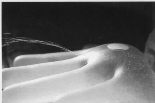
Figura 4. Defecto en forma de orificio macroscópico visible con el test de relleno con agua en un guante de vinilo.
