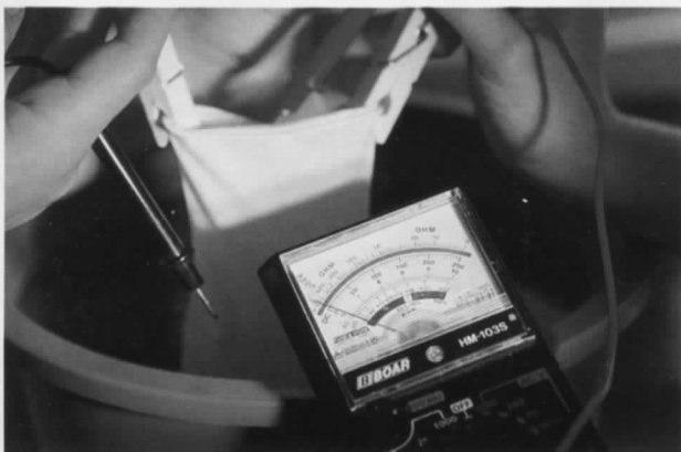
Figuras 2 y 3. Test de conductividad eléctrica. Cada guante se rellena con solución salina y se sumerge en un baño de la misma solución. Colocamos un electrodo del voltímetro en el interior del guante y otro en el baño circundante. El volumen del flujo en voltios indicado es proporcional al tamaño del defecto microscópico. Un valor de 10 indica la presencia de un defecto macroscópico visible.
