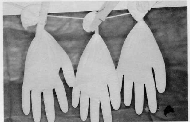
Figura 1. Una vez realizado el examen visual, se somete cada guante al test de relleno con agua.
