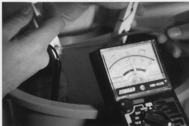
Figuras 2 y 3. Test de conductividad eléctrica. Cada guante se rellena con solución salina y se sumerge en un baño de la misma solución. Colocamos un electrodo del voltímetro en el interior del guante y otro en el baño circundante. El volumen del flujo en voltios indicado es proporcional al tamaño del defecto microscópico. Un valor de 10 indica la presencia de un defecto macroscópico visible.
