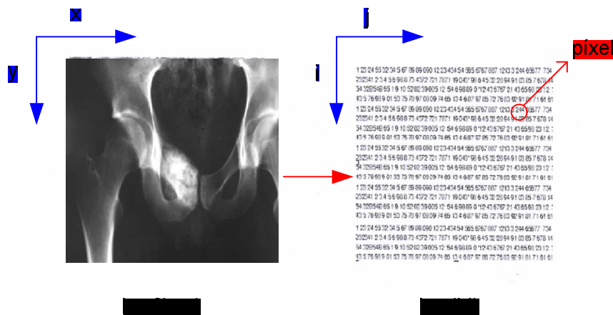
Figura 2. Imagen analógica (radiografía) e imagen discreta (matriz numérica) resultante del proceso de digitalización.
