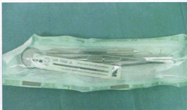
Figura 16. Monitorización química. Test Bowie-Dick
