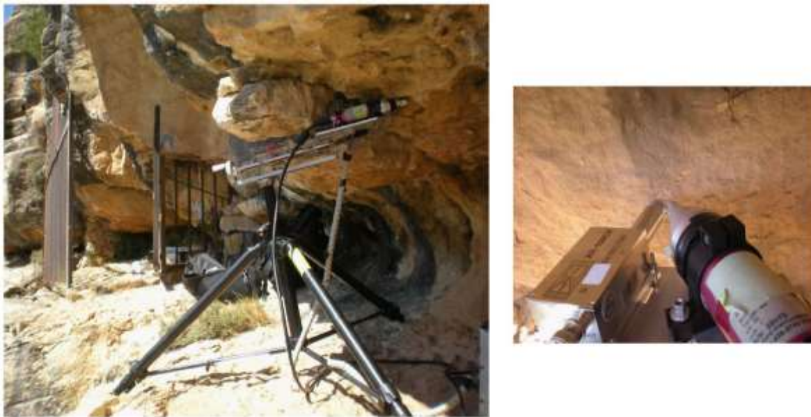
Figura 4 Utilización de un espectrómetro EDXRF portátil en el conjunto levantino de Les Dogues (Castellón). Fuente: López-Montalvo et alii, (2017)
