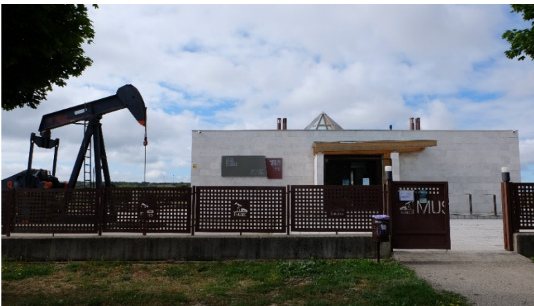
Figura P4.7. A) Entrada del Museo del Petróleo, a Sargentos de la Lora. A l'esquerra de la fotografia es pot veure un "cavallet", que és una bomba de balancí que s'utilitzava per a bombejar mecànicament els hidrocarburs del reservori.
