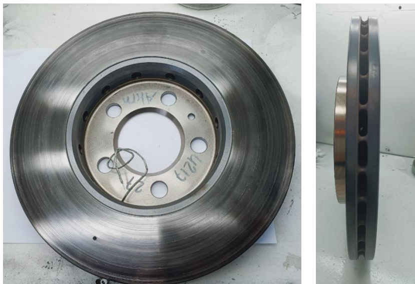
Figura 3.2. Imágenes del rotor ventilado de fundición gris de EURAC.
