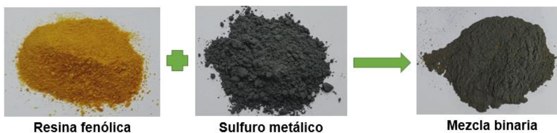
Figura 3.1. Esquema de la preparación de las mezclas binarias de resina fenólica - sulfuro metálico.
