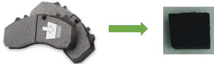
Figura 3.10. Zona y dirección de corte de la pastilla de freno para la preparación metalográfica de la sección transversal y pieza obtenida tras el corte.
