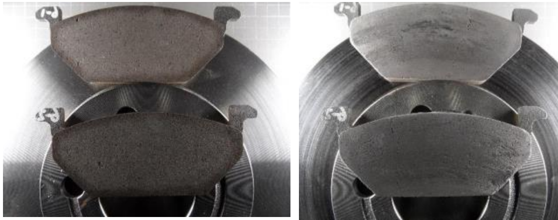
Figura 3.5. Pastilla y disco de freno de F4 antes (izquierda) y después (derecha) del ensayo SAE J2522.
