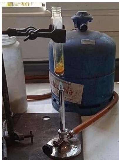
Figura 3.9. Sistema de tratamiento térmico de las mezclas de resina fenólica y sulfuro metálico.
