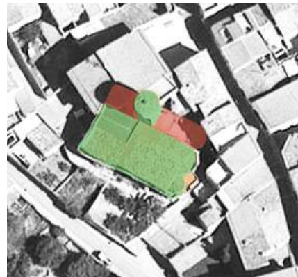
Figura 15. En verd les zones de l'església que encara es conserven. En vermell, la nau de l'Evangeli actualment desapareguda i de la que queden restes. (Font: Cartoteca Digital ICGT)
