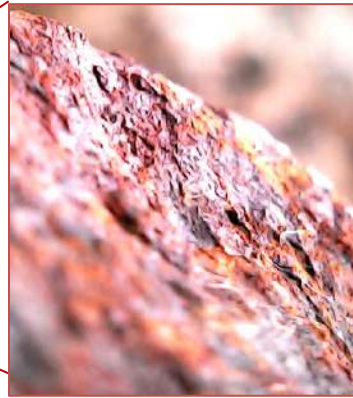
Figura 60. Element metàl·lic que presenta un avançat grau d'oxidació, a través del microscopi de superfície digital. (Font pròpia)
