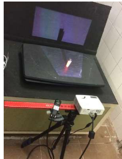
Fig 13. Imagen de proceso. Se observa la luz estructurada proyectada sobre el objeto que se quiere escanear. (Imagen de autoría propia)
