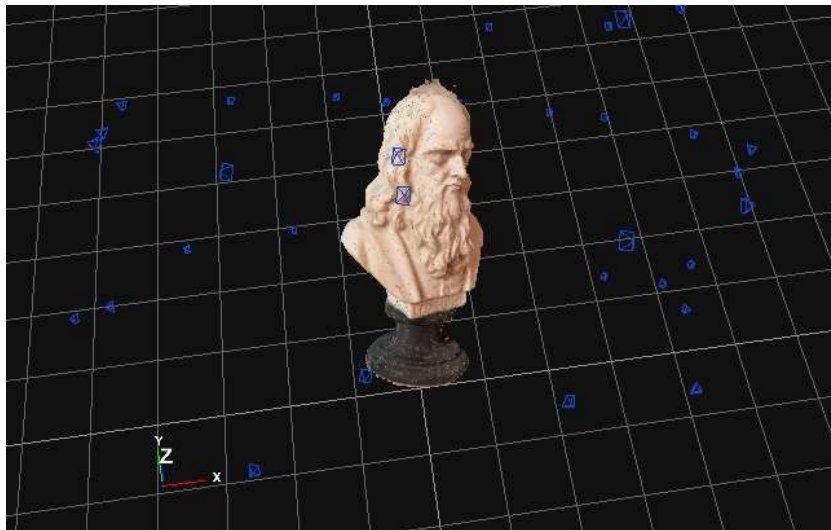
Fig 16. Último paso del proceso de fotogrametría. Se observa la malla final con textura. Se han eliminado manualmente los puntos que no formaban parte de la obra. Imagen de autoría propia
