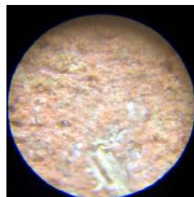
Figura 15, se observa superficie de un ladrillo a 100x. No se aprecian los poros, pero si la suciedad incrustada en ellos.
