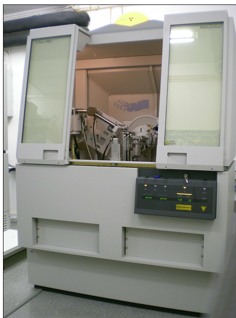
Figura II.31. Difractòmetre PANalytical X'Pert PRO MPD en ús a la Unitat de DRX dels SCT de la UB. En configuració de K\alpha_1 i plataforma Sample Spinner .
