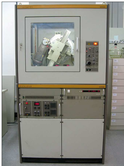
Figura II.1. Vista global del difractòmetre Siemens D-500 S1 en la seva ubicació actual.
