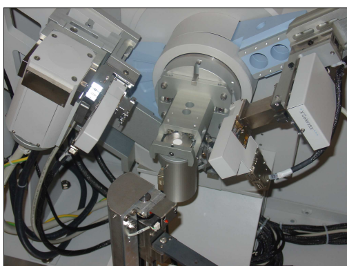
Figura II.23b. Goniòmetre de l'equip X'Pert PRO MPD Alpha-1. Configuració de K\alpha_{1+2} , plataforma portamostres amb spinner PW3064/00 i detector X'Celerator.
