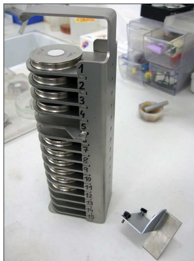
Figura II.28. Magazine del carregador de mostres de 15 posicions, i beam-knife per la plataforma portamostres Sample Spinner PW3064/00 .
