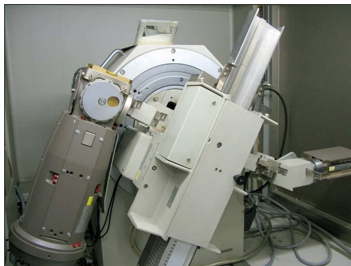
Figura II.5. Difractòmetre Siemens D-500 S1. Detall del goniòmetre amb la configuració de carregador de mostres, monocromador secundari i detector puntual.
