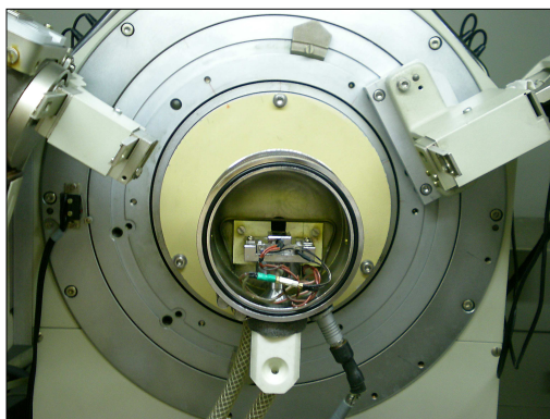
Figura II.10. Difractòmetre Siemens D-500 S2 . Detall del goniòmetre amb la cambra de temperatura A PAAR TTK, monocromador secundari i detector puntual.
