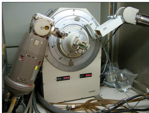
Figura II.8. Difractòmetre Siemens D-500 S2 . Detall del goniòmetre amb la configuració de portamostres estàndard, dispositiu d'incidència rasant amb monocromador en disposició paral·lela i detector puntual.
