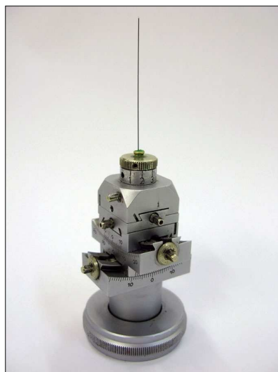
Figura II.37. Capçal goniomètric de la plataforma portamostres per capil·lars en rotació PW3063/00 . Mostra de Silici SRM-640c en un capil·lar glass number. 140 de 0.3 mil·límetres
