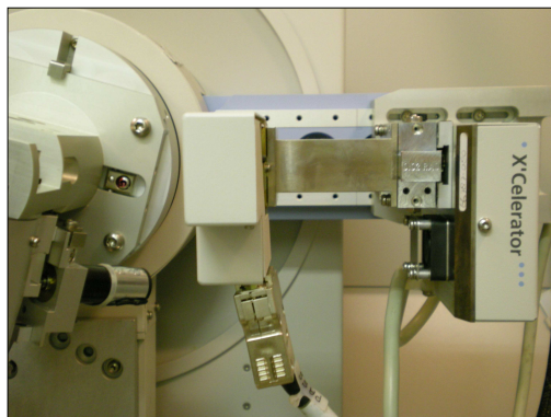
Figura II.30. Òptica PreFIX del feix difractat del difractòmetre Alpha-1 de la Unitat de DRX dels SCT de la UB.
