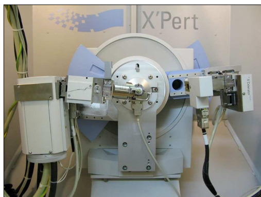
Figura II.38a. Goniòmetre del difractòmetre PANalytical X'Pert PRO MPD \theta/\theta , amb la configuració d'òptica paral·lela amb monocromador híbrid i portamostres per capil·lars en rotació.
