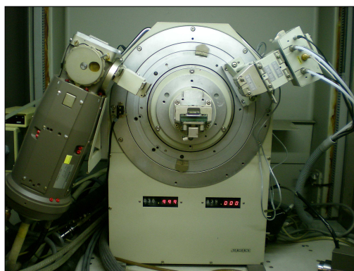
Figura II.9. Difractòmetre Siemens D-500 S2 . Detall del goniòmetre amb la configuració de portamostres estàndard, filtre de Níquel i detector PSD .
