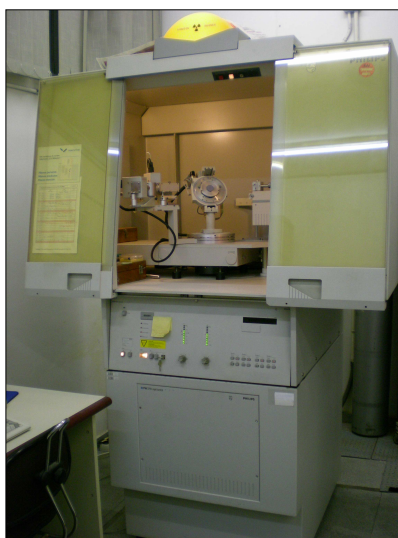
Figura II.17. Vista global del Difractòmetre Philips MRD en la seva ubicació actual.
