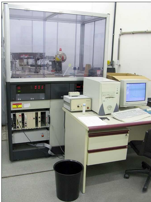
Figura II.13. Difractòmetre Inel CPS-120 en ús a la Unitat de DRX dels SCT de la UB.
