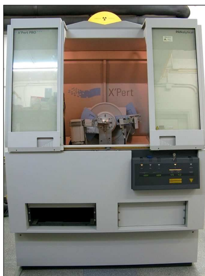
Figura II.38b. Difractòmetre PANalytical X'Pert PRO MPD \theta/\theta en ús a la Unitat de DRX dels SCT de la UB. En configuració d'òptica paral·lela i portamostres per capil·lars en rotació.
