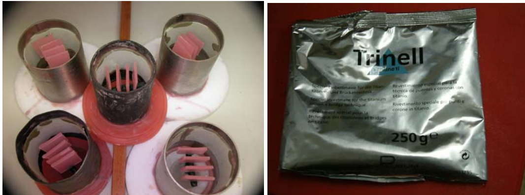
Fig. 4.12 y 4.13. Cilindro montado para planchas de Titanio a punto para vaciar el revestimiento y Material de Revestimiento para Titanio (Trinell® de Dentaaurum®, Ispringen, Alemania).
