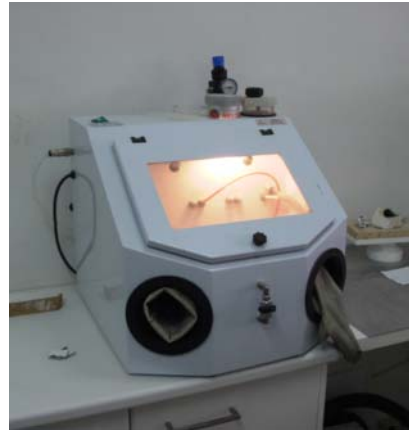
Fig.4.28 y 4.29. Revestimiento para aleaciones de Cr-Ni y Cr-Co (Ceramvest ® , Protechno ® , Vilamalla, España). Y primer arenado del Cr-Ni y Cr-Co. Arenadora de Óxido de Aluminio ( Al_2O_3 ) Mestra ® , Bilbao, España.
