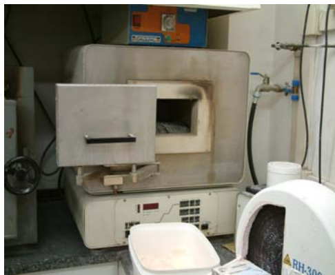
Fig. 4.22 y 4.23. Horno para calentamiento del cilindro del Ti. Rematitan® Autocast Dentaaurum®, Ispringen, Germany
