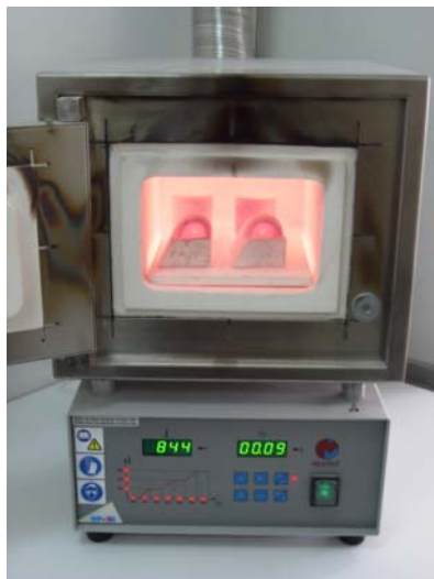
Fig. 4.18. Horno para colar Cr-Ni y Cr-Co Mestra® HP-50, Bilbao, España. Pre calentamiento del horno para colar.
