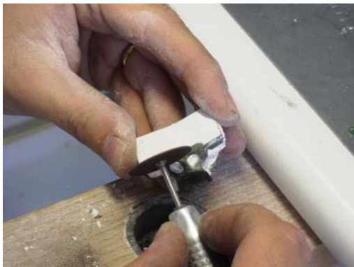
Fig. 4.30 y 4.31. Separación con disco de carburo del Cr-Ni y Cr-Co. Motor de laboratorio y pieza de mano Kavo ® K-4 Plus, Leutkirch, Alemania. Disco de Carburo de Silicio tipo Schuler de Komet ® Gebr. Brasseler GmbH & Co. KG, Lemgo, Alemania.
