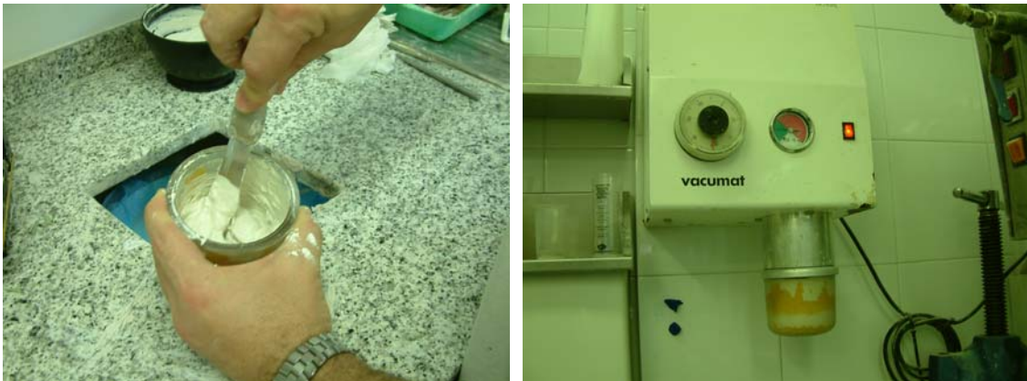
Fig. 4.14 y 4.15. Material de revestimiento para colado de Titanio mezclándose antes de colocarlo a la batidora. Máquina mezcladora (batidora) de yeso para revestimiento con compresor Mestra® Iris 080518, Bilbao, España.
