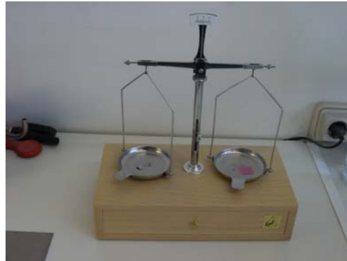
Fig. 4.11. Balanza de precisión manual Kiesel® de dos platos 100 y 250 gr., Sant Cugat del Valles, España. Utilizadas para el peso de las aleaciones y de la cera.
