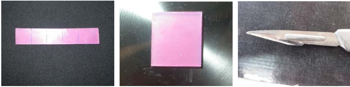
Fig. 4.2. (a, b, c) Corte de la Cera Reus ® Spain de 1.8 x 1.8 y Bisturí con hoja del número 11, Swam-Morton ® , Sheffield, England.
