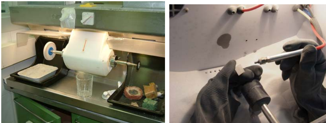
Fig. 4.40 y 4.41. Discos y cepillos de algodón para el brillo del metal Mestra® Bilbao, España. Fig. 4.48. Segundo arenado del Ti. Arenadora de Óxido de Aluminio (Al 2 O 3 ) Mestra®, Bilbao, España.
