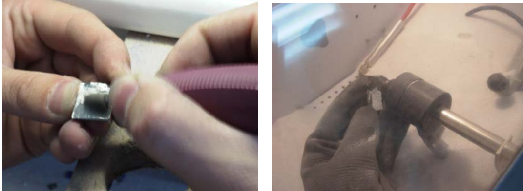
Fig. 4.32 y 4.33. Desbastado con Piedra abrasiva tipo Faiot montada en corindon de grano medio de Komet® Gebr. Brasseler GmbH & Co. KG, Lemgo, Alemania. y segundo arenado del Cr-Ni y Cr-Co Arenadora de Óxido de Aluminio (Al 2 O 3 ) Mestra®, Bilbao, España.
