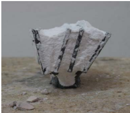
Fig.4.28 y 4.29. Revestimiento para aleaciones de Cr-Ni y Cr-Co (Ceramvest ® , Protechno ® , Vilamalla, España). Y primer arenado del Cr-Ni y Cr-Co. Arenadora de Óxido de Aluminio ( Al_2O_3 ) Mestra ® , Bilbao, España.
