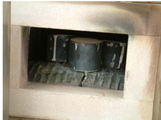
Fig. 4.22 y 4.23. Horno para calentamiento del cilindro del Ti. Rematitan® Autocast Dentaaurum®, Ispringen, Germany
