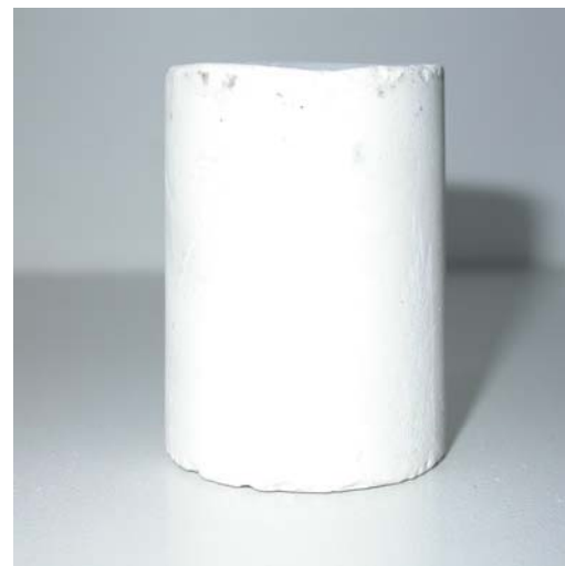
Fig. 4.9 y 4.10. Máquina vibradora para vaciado de yesos Mestra ® Circular, Bilbao, España. Material de Revestimiento para aleaciones de Cr-Ni y Cr-Co (Ceramvest ® , Protechno ® ), Vilamalla, España. vaciándose en el cilindro de colado. Cilindro de revestimiento una vez endurecido durante 45 min.
