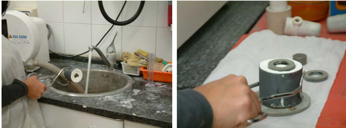
Fig. 4.26 y 4.27. Enfriamiento del cilindro del Ti con agua a temperatura ambiente.
