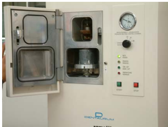
Fig. 4.24 y 4.25. Máquina para colar Titanio (Rematitan® Autocast Dentaaurum®, Ispringen, Germany). Colado del titanio.
