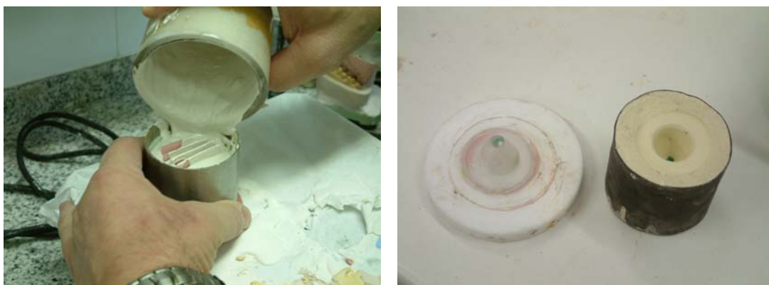
Fig. 4.16 y 4.17. Vaciado del material de revestimiento al cilindro para colar las planchas de Titanio en una Máquina vibradora para vaciado de yesos Mestra® Circular, Bilbao, España. Y Cilindro una vez fraguado y extraída la base, a la vista el crisol.
