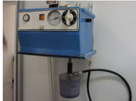
Fig. (4.8 a, b). Material de Revestimiento para aleaciones de Cr-Ni y Cr-Co (Ceramvest ® , Protechno ® , Vilamalla, España). Colocado en la mezcladora, se mezcla durante 30 segundos y vaciado. Máquina mezcladora (batidora) de yeso para revestimiento con compresor Mestra ® Iris 080518, Bilbao, España.
