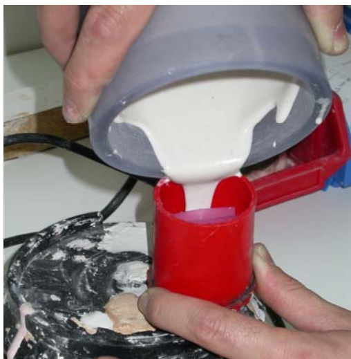
Fig. 4.9 y 4.10. Máquina vibradora para vaciado de yesos Mestra ® Circular, Bilbao, España. Material de Revestimiento para aleaciones de Cr-Ni y Cr-Co (Ceramvest ® , Protechno ® ), Vilamalla, España. vaciándose en el cilindro de colado. Cilindro de revestimiento una vez endurecido durante 45 min.
