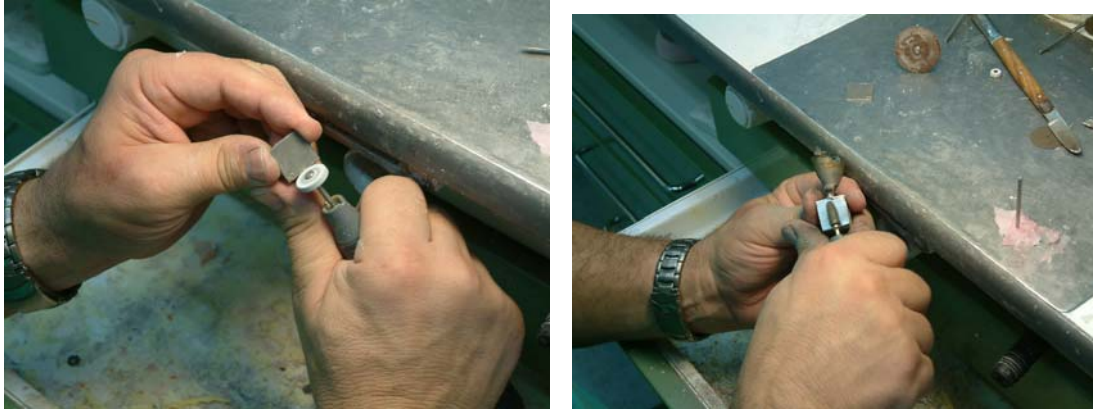
Fig. 4.38 y 4.39. Pulido del titanio. Motor de laboratorio y pieza de mano Kavo® K-4 Plus, Leutkirch, Alemania. Piedra de pulir metal montada de grano medio de Komet® Gebr. Brasseler GmbH & Co. KG, Lemgo, Alemania. Piedra abrasiva tipo Faiot montada en corindon de grano medio de Komet® Gebr. Brasseler GmbH & Co. KG, Lemgo, Alemania.
