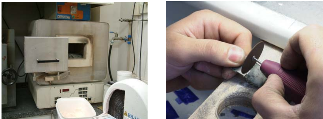
Fig. 4.36, 4.37. precalentamiento del horno Dentaurem ® Ispringen, Germany. Para el Ti. Cortado y pulido del titanio. Motor de laboratorio y pieza de mano Kavo ® K-4 Plus, Leutkirch, Alemania. Disco de Carburo de Silicio tipo Schuler de Komet ® Gebr. Brasseler GmbH & Co. KG, Lemgo, Alemania.
