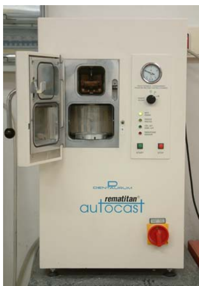
Fig. 4.24 y 4.25. Máquina para colar Titanio (Rematitan® Autocast Dentaaurum®, Ispringen, Germany). Colado del titanio.
