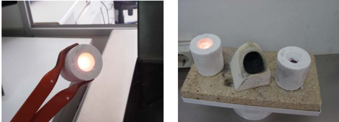
Fig. 4.20, 4.21. Enfriamiento del cilindro de Cr-ni, Cr-co, a temperatura ambiente.
