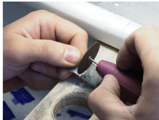
Fig. 4.30 y 4.31. Separación con disco de carburo del Cr-Ni y Cr-Co. Motor de laboratorio y pieza de mano Kavo ® K-4 Plus, Leutkirch, Alemania. Disco de Carburo de Silicio tipo Schuler de Komet ® Gebr. Brasseler GmbH & Co. KG, Lemgo, Alemania.
