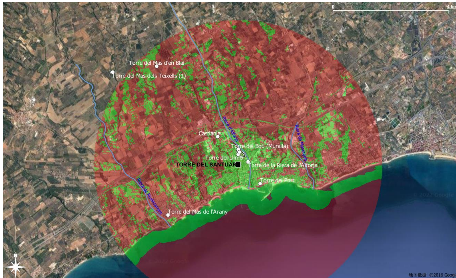
[Fig. D-12] Conca visual de la Torre del Santuari del Camí, calculada a partir d'una capa ràster MDT de 5 m i en un radi de 5 km. El color verd indica les zones visibles des de la torre; i el vermell, les no visibles.
