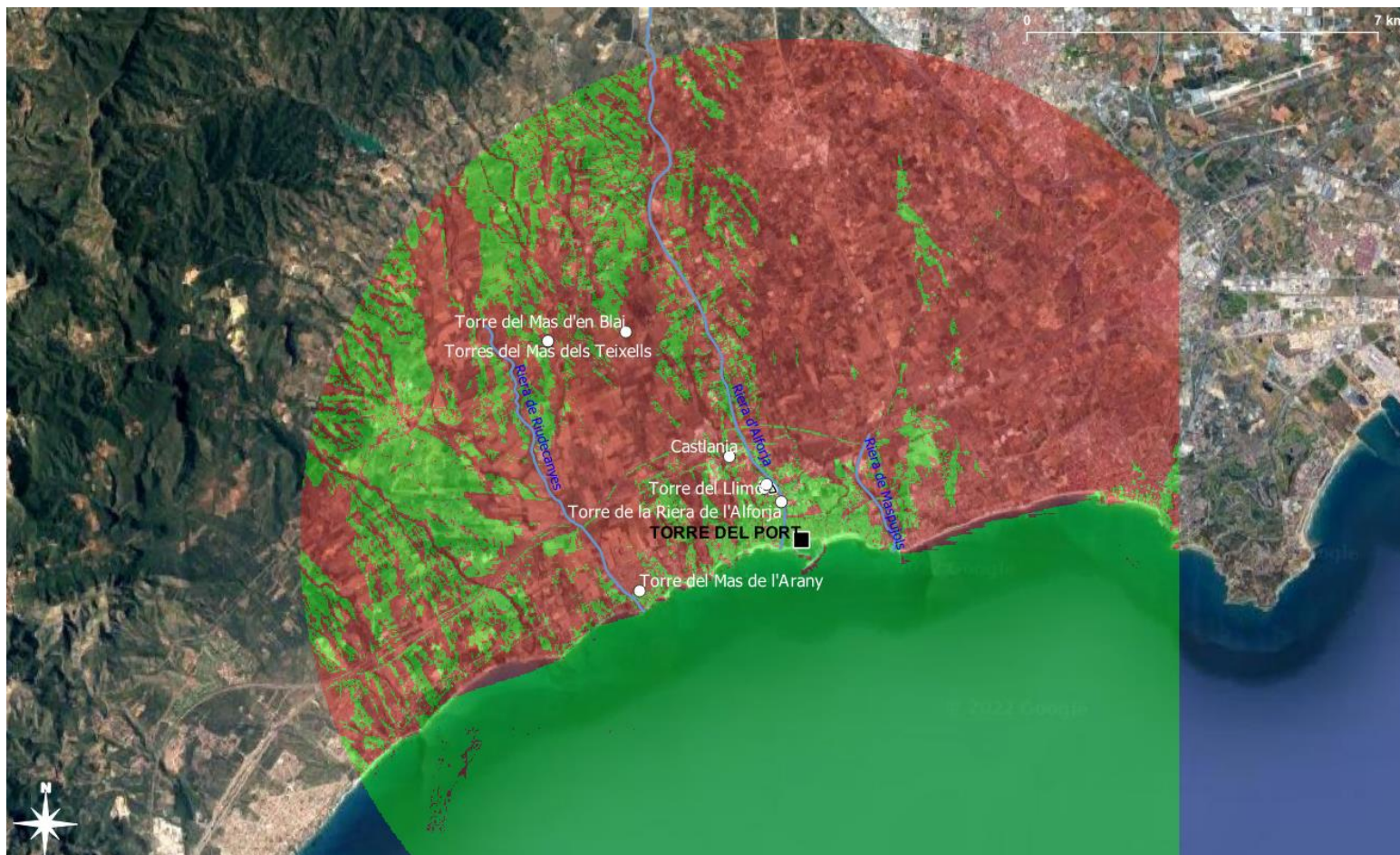
[Fig. D-10] Conca visual de la Torre del Port de Cambrils, calculada a partir d'una capa ràster MDT de 25 m i en un radi de 10 km. El color verd indica les zones visibles des de la torre; i el vermell, les no visibles.
