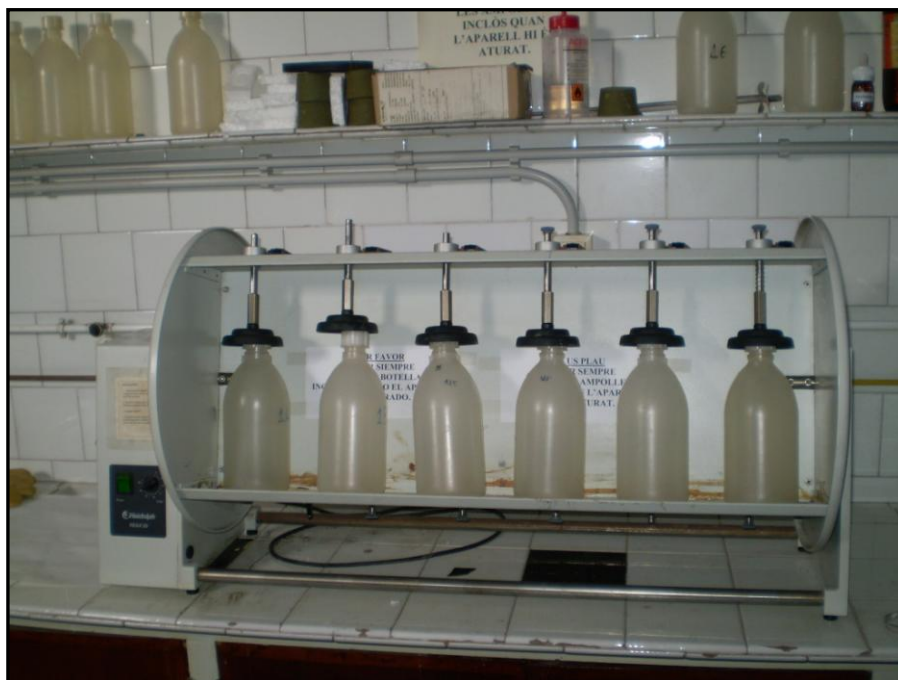
Figura 4. Agitador mecánico usado para la homogenización de las muestras para el método Bouyoucos.
