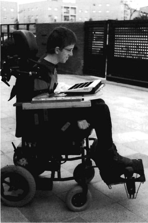
**Fig. 12-1.** Ángel se desplaza con su silla de ruedas que controla con un mando situado en los pies. Lleva acoplado a la silla el comunicador Alpha Talker con el conmutador a la altura de su hombro. (Cortesía de Fundació l'Espiga.)
