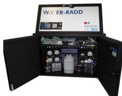
Figura 4. Equipo para la medida en continuo de la actividad alfa y beta en aguas prepotables
