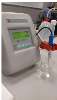
Figura 30. Crisóm pH-meter GLP 22. Elaboració pròpia
