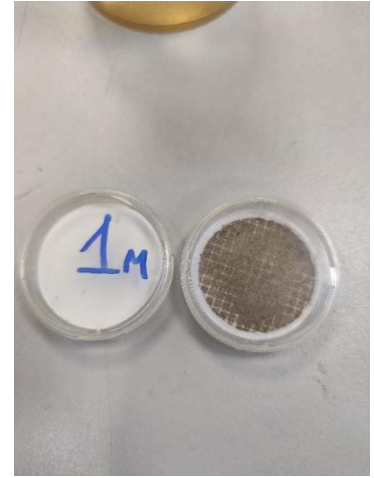
Figura 33. Filtres amb sediments. Elaboració pròpia
