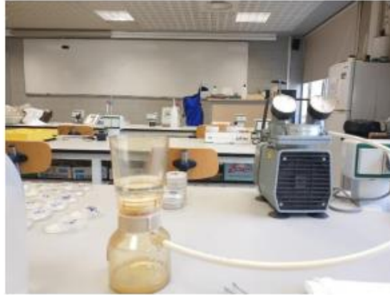
Figura 32. Anàlisi dels sediments en suspensió, filtrats a través de Millipore. Font: David Calleja
