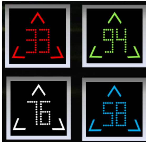
Figura 2 – Prototipo del marcador visual de los muros
