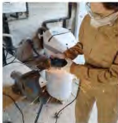
FIGURA 23 . Corte en ángulo para formar el asiento.
