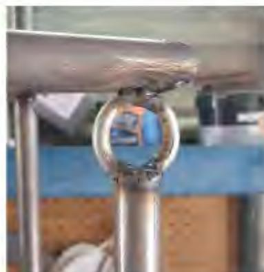
FIGURA 27. Calentamiento del tubo con soplete directo para crear corbату-
