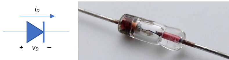
Figura 22. Símbol de circuit del díode PN i imatge d'un díode 1N4148 de silici.
