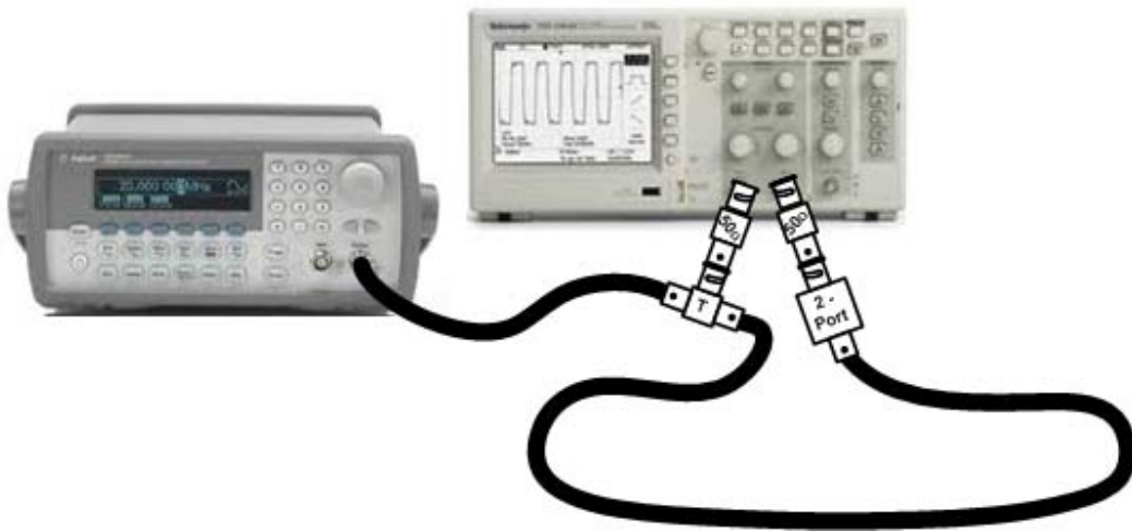
Figura 4: Connexió per mesurar un 2-port.
