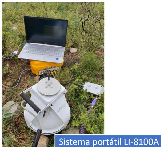
Figura 17. Medición del flujo de CO<sub>2</sub> con LI-8100A.
