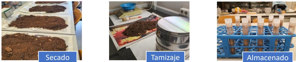
Figura 9. Secado, tamizaje y almacenamiento de las muestras en laboratorio.
