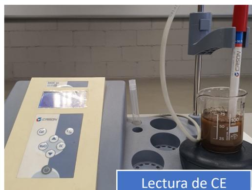
Figura 14. Medición de Conductividad Eléctrica en laboratorio.
