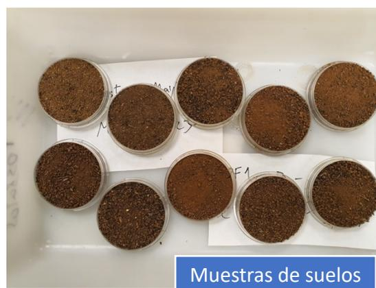
Figura 12. Preparación de muestras para prueba de hidrofobicidad.
