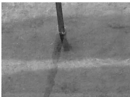
Regle de fusta vàlid per a mesurar la fondària del riu (Font: Arxiu propi)
