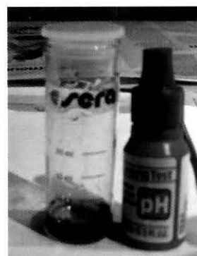
Reactiu i resultat d'una prova de pH: el resultat és de 9,0. (Font: Arxiu propi)
