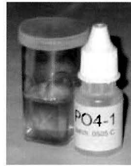
Reactiu i resultat d'una prova de fosfats: el resultat és 0,25 mg/l. (Font: Arxiu propi)
