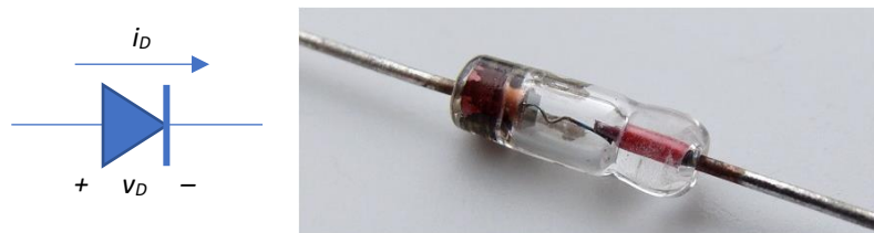
Figura 22. Símbol de circuit del díode PN i imatge d'un díode 1N4148 de silici.
